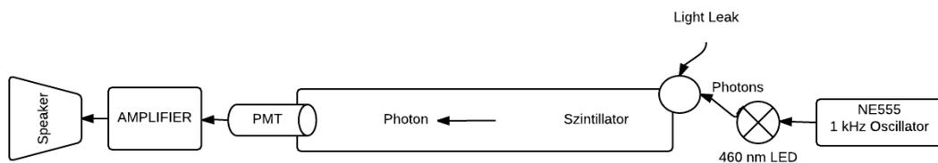
Abbildung 6.2.: Prinzip des akustischen Lichtleckfinders. Blaues Licht, welches mit einem Rechtecksignal von 1 kHz moduliert ist, tritt durch Löcher in der Verpackung in den Szintillator ein und wird durch den Photomultiplier in ein elektrisches Signal umgewandelt, dessen 1 kHz Modulation mit einem Lautsprecher wiedergegeben werden kann.
