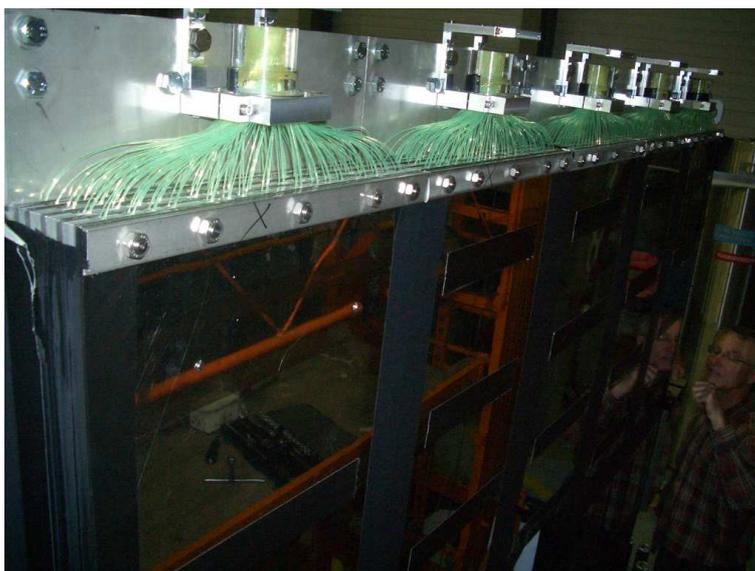
Abbildung 3.8: Lichtleiter aus den Modulen, die zu den Halterungen für die Photomultiplier führen
