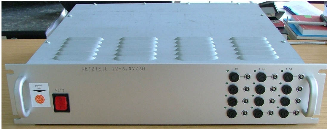
Abbildung 5.2: Das Netzteil zur Versorgung der LVDS-Splitter-Platinen. Abmessungen: BxTxH, (483)435x410x100 mm 3 . Design F. Bilger.
