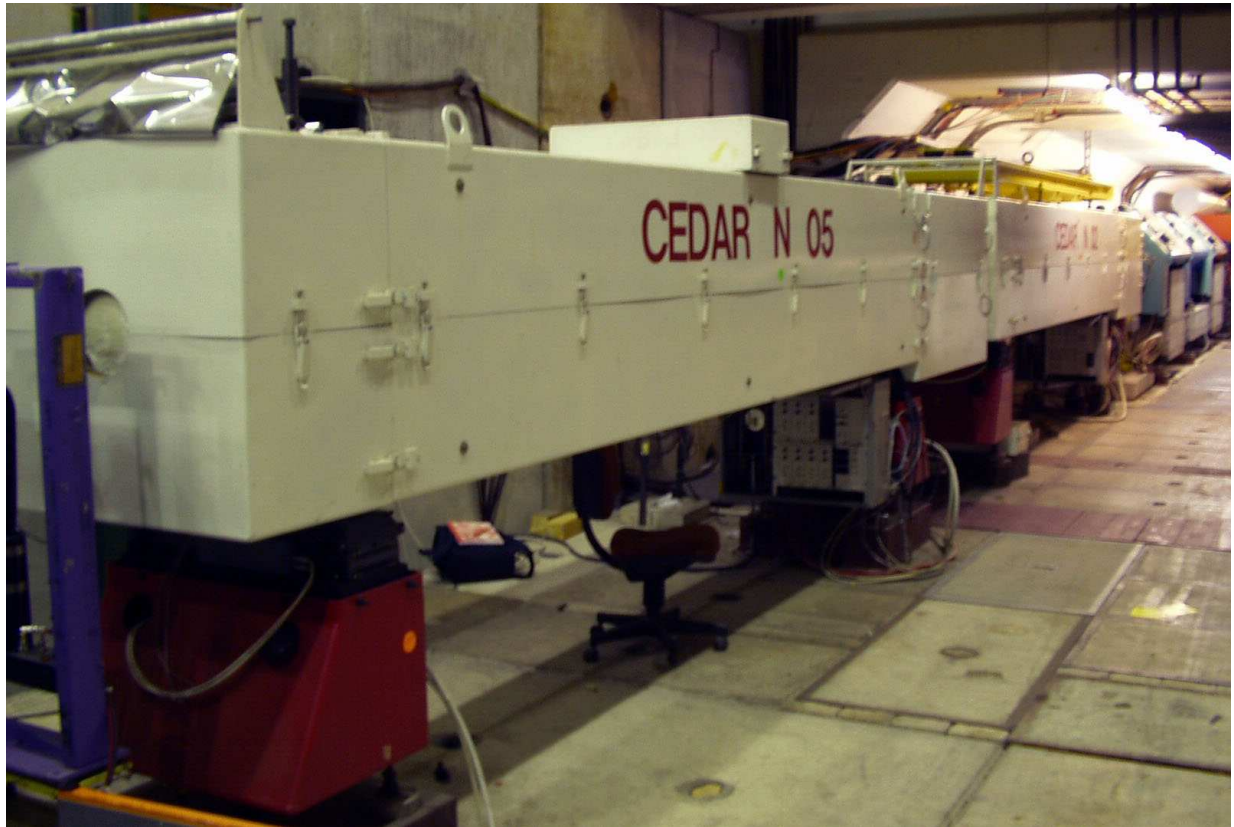
Abbildung 6: Beide CEDAR-N in der M2-Strahlführung (Blickrichtung strahlaufwärts). Der eigentliche Gas-Detektor ist durch eine 10 cm dicke PU-Schaumschicht isoliert. Die dünne Blechverkleidung dient dem mechanischen Schutz.
