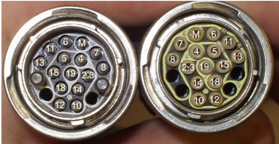
Abbildung 51: Belegung der Pins an den Steckern und Buchsen der BURNDY-Kabel zwischen CEDAR-PMTs und Spannungsteiler.
