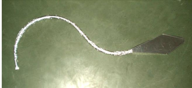
**Abbildung 5.12:** gekrümmter zylindrischer Lichtleiter mit Fishtail und Szintillator
