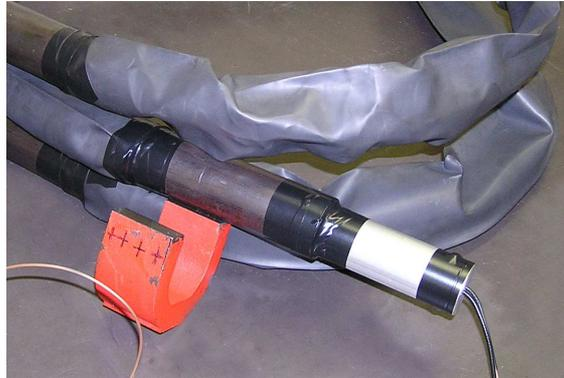
**Abbildung 5.43:** Magnetfeldmessungen: Mit dem Messaufbau wurden ADC-Spektren mit unmittelbar am Photomultiplier angelegten Permanentmagneten genommen.
