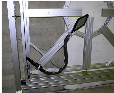
**Abbildung 5.19:** Fertig montierter Szintillationszähler auf einem Zählerträger des Vetodetektor-Rahmens.
