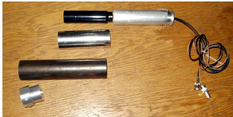
Abbildung 5.18: Photomultiplier mit Basis, Verbindungsmanschette aus Aluminium, Eisenzylinder,  $\mu$ -Metall, Aluminiumröhren, Cookie Aluminiumzylinder und Aluminiummanschette dienen zur sicheren Verbindung von Lichtleiter.
