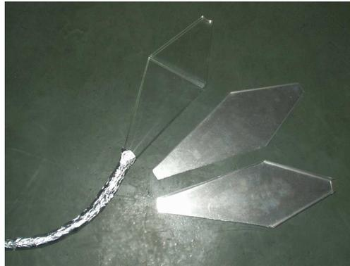
**Abbildung 5.15:** Szintillator, Fishtail, Lichtleiter (bereits in Aluminiumfolie verpackt) und Alubox.
