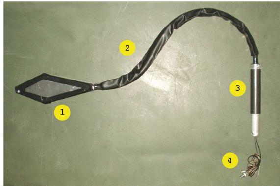
**Abbildung 5.8:** Einer der für den Vetodetektor “Inner 2” verwendeten Szintillationszähler; 1) in einer Aluminiumbox verpackter Szintillator und Fishtail-Lichtleiter, 2) zylinderförmiger, gebogener Lichtleiter, verpackt in Aluminiumfolie und einen Schrumpfschlauch, 3) Photomultiplier, verpackt in  $\mu$ -Metall und eine Eisenröhre, 4) Signal- und Hochspannungsanschlüsse des Photomultipliers.
