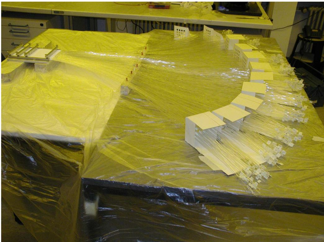
**Abbildung C.3:** Detektormodul FI06V aus insgesamt 704 Fasern. Jede Faser erhält zur eindeutigen Identifizierung eine Markierung und wird in eine Matrix eingeordnet, die dem Kathodenraster des H6568 nachgebildet ist.
