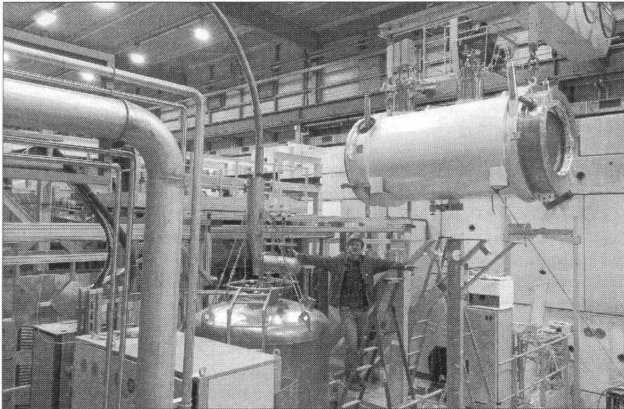
Le nouvel aimant de COMPASS, qui permettra une acceptance maximum, est installé dans l'expérience.
