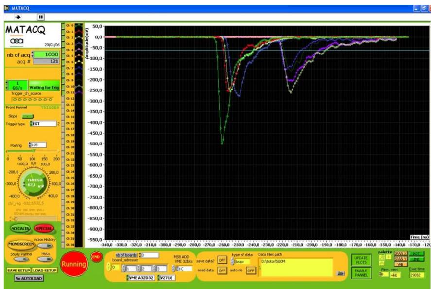
FIG. 6.8 - Capture d'écran de l'interface du programme Matacq. On peut voir la forme des signaux avec leurs points toutes les nanosecondes, marquant l'échantillonnage du signal.
