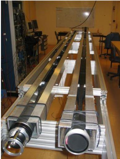
FIG. 5.12 - Cadre de maintien des compteurs de type A.
