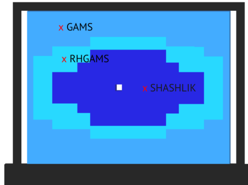
Abbildung 5.2: Die, für die Extraktion der Schauerparameter eines Modultyps simulierten, Photonen trafen jeweils bei dem roten x neben dem Modultypnamen auf die ECAL2 Ebene; in Schwarz sind tragende Strukturen von ECAL2 dargestellt, in den drei Blautönen die verschiedenen Modultypen
