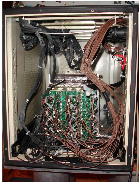
Abbildung 5.2: links: 25 GAMS-Module, angeordnet in 5x5-Matrix, Ansicht von Photomultiplier hin zu Bleiglasblock; rechts: GAMS-Module eingelegt in Versuchsbox und angeschlossen an Basen und Ausleseelektronik
