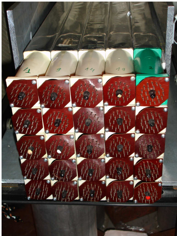
Abbildung 5.2: links: 25 GAMS-Module, angeordnet in 5x5-Matrix, Ansicht von Photomultiplier hin zu Bleiglasblock; rechts: GAMS-Module eingelegt in Versuchsbox und angeschlossen an Basen und Ausleseelektronik
