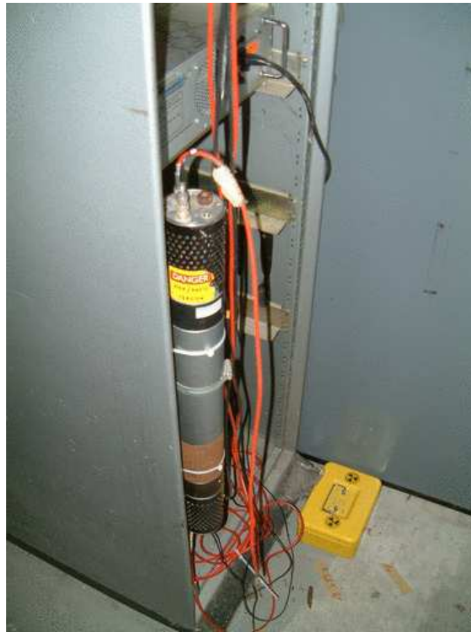
Abbildung 5.1: Abgebildet ist das Gehäuse des Zufalls-Generators und der Photomultiplier (Zylinder), befestigt an der Rückwand eines NIM-Crates.
