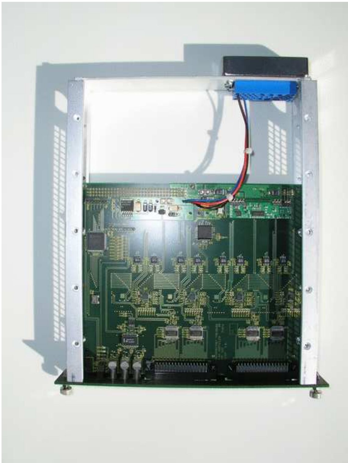
Abbildung B.8: Die Abbildung zeigt das NIM-LVDS 1-64 Verteilermodul von der Seite für den NIM-Einschub.
