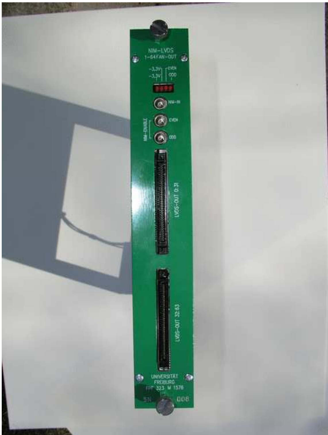
Abbildung B.10: Die Abbildung zeigt das NIM-LVDS 1-64 Verteilermodul für den NIM Einschub von vorne. Zu erkennen sind die Buchsen für die Eingangssignale (NIM-IN, EVEN-, ODD-NIM-ENABLE) sowie die Stecker für die 64 Ausgangssignale (LVDS-OUT 0:31 und LVDS-OUT 32:63).
