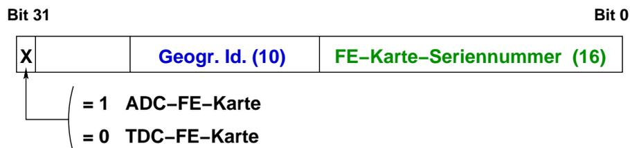
**Abbildung 5.5:** Der HOTLink-CPLD gibt die Position der Front-End-Karte am Detektor (Geogr. Id) und die serielle Nummer an das CATCH-Modul weiter. Zusätzlich dazu wird mitgeteilt, ob es sich um eine ADC- (Bit 31 = 1) oder TDC-FE-Karte (Bit 31 = 0) handelt.
