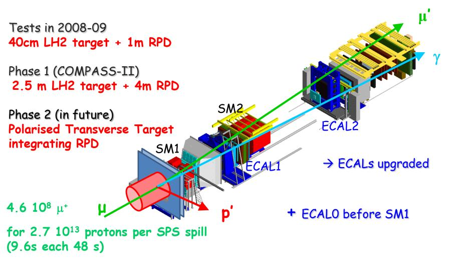
$\rightarrow$  Lumi= 10<sup>32</sup> cm<sup>-2</sup> s<sup>-1</sup> with 2.5m LH2 target
